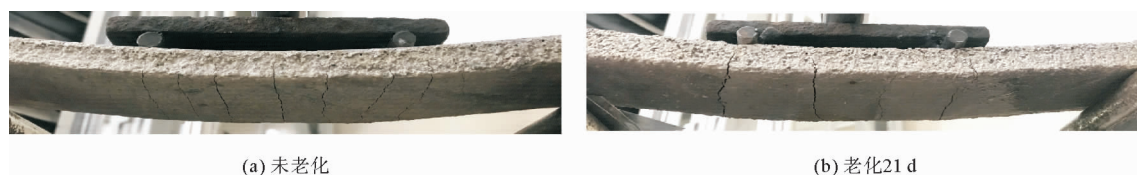
图 6 老化前后 BTR-O 板的裂缝数量
