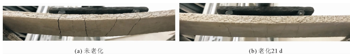
图 7 老化前后 BTR-H 板的裂缝数量
