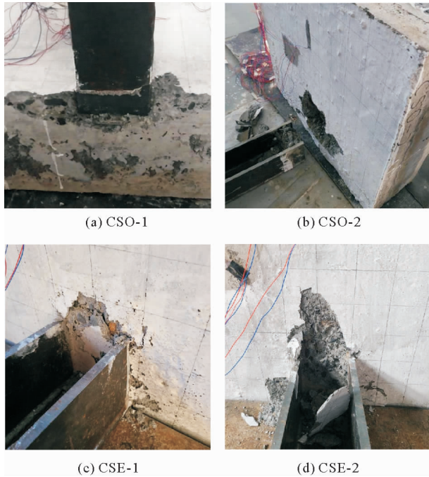
图 9 CS 外墙挂板试件破坏形态图
