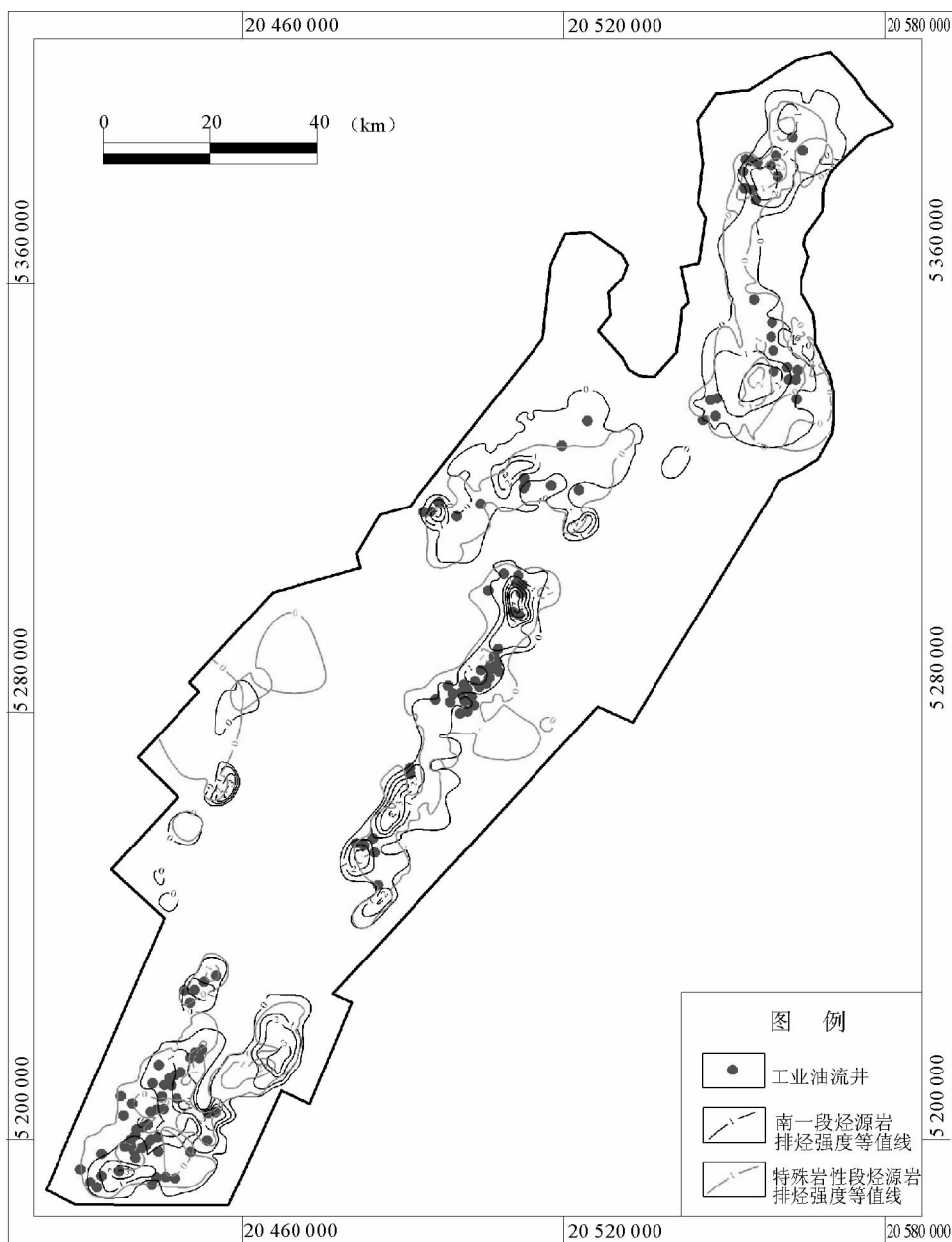
图 3 海塔盆地中部主要断陷带 2 套主力烃源岩与南一段油藏之间分布关系图
