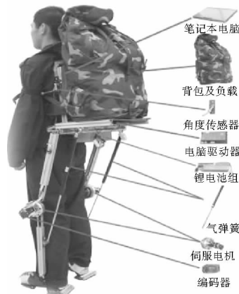
图 13 海军航空工程学院的第一代骨骼服样机 Fig. 13 The first generation exoskeleton suit prototype of Naval Institute of Aeronautical Engineering
