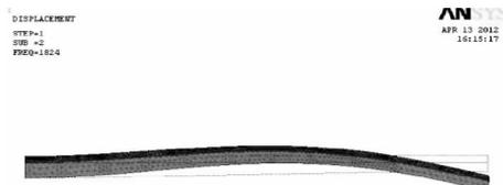
图 13 二阶模态振型图 ( $T=45\text{ }^{\circ}\text{C}$ )
