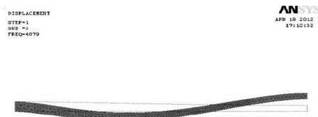
图 14 三阶模态振型图 ( $T=45\text{ }^{\circ}\text{C}$ )
