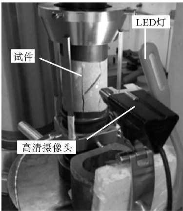
图1 单轴荷载下裂隙扩展监测装置
