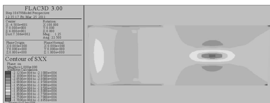
图 4 距陷落柱 70 m 水平应力示意图 Fig. 4 The sketch of horizontal stress at 70 m away from subsided column
