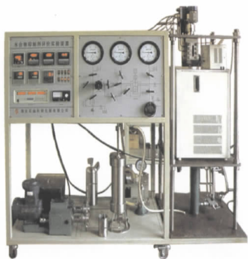
图 1 水合物抑制与分解评价实验装置图
