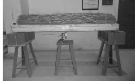
(b) 试验加载装置图 (b) Test loading device
