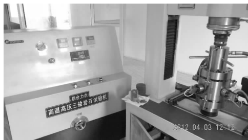
图1 高温高压三轴环境试验机系统
