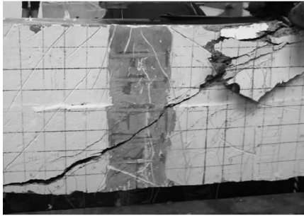
图 11 试验梁 JQL2 破坏形态
