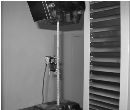
图 5 钢筋拉伸试验
