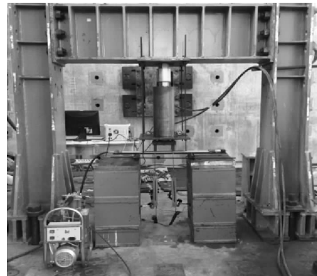
图 2 充压管道四点弯曲实验装置图
