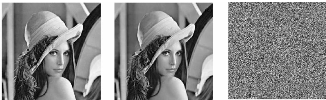
(a) 原始图像 ; (b) 正确密钥解密的图像 ; (c) 错误密钥解密的图像
