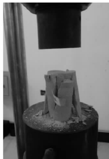
(b) 粗砂岩试件的破坏形态
