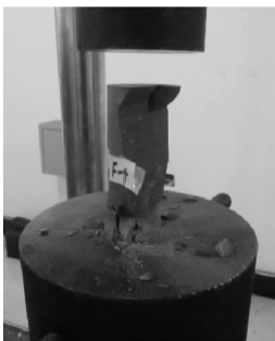
(a) 细砂岩试件破坏形态
