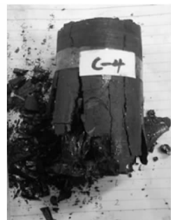
(c) 煤试件破坏形态
