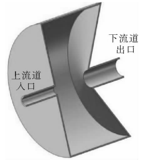
图 5 Helmholtz 喷嘴腔室模型
