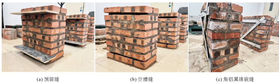
图 2 试件砌筑和嵌缝过程
