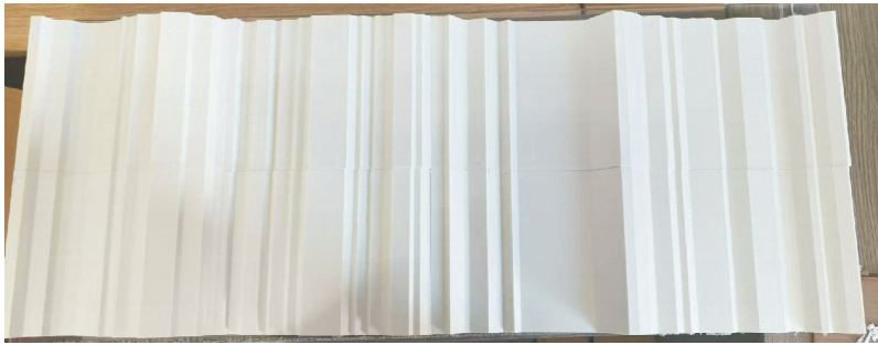
图 13 3D 打印的粗糙裂隙模型
