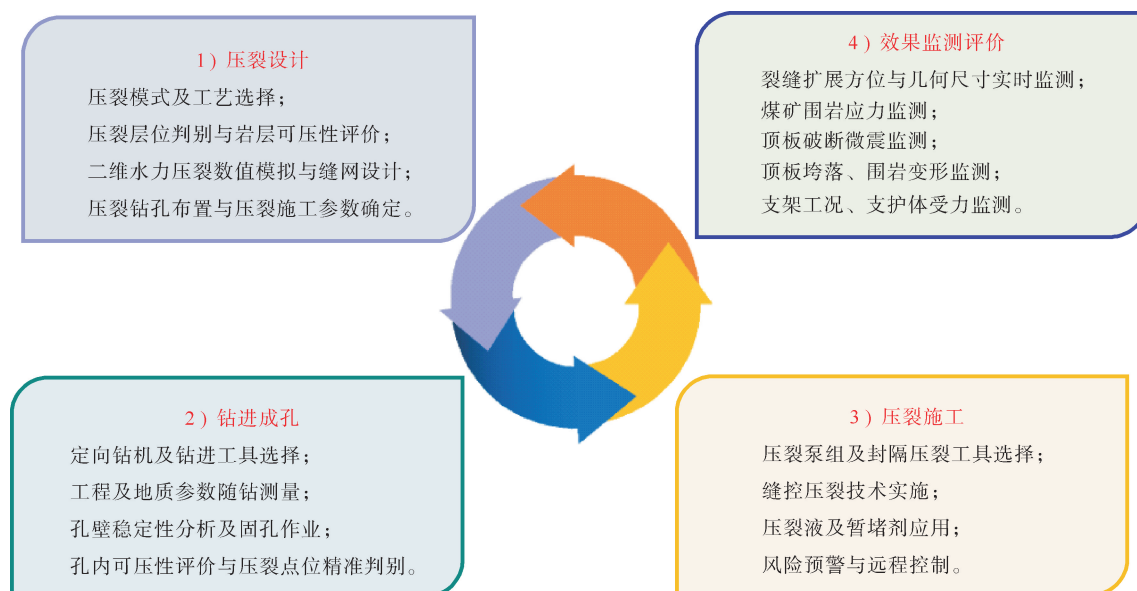
图2 煤层压裂技术实施流程
