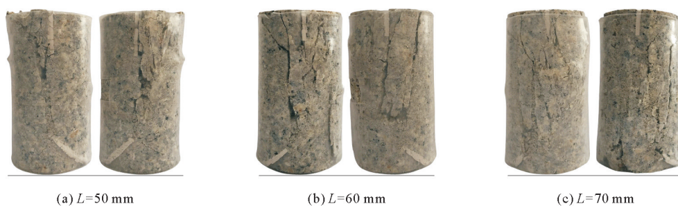
图 10 多级增幅循环荷载下裂隙花岗岩宏观破坏模式
